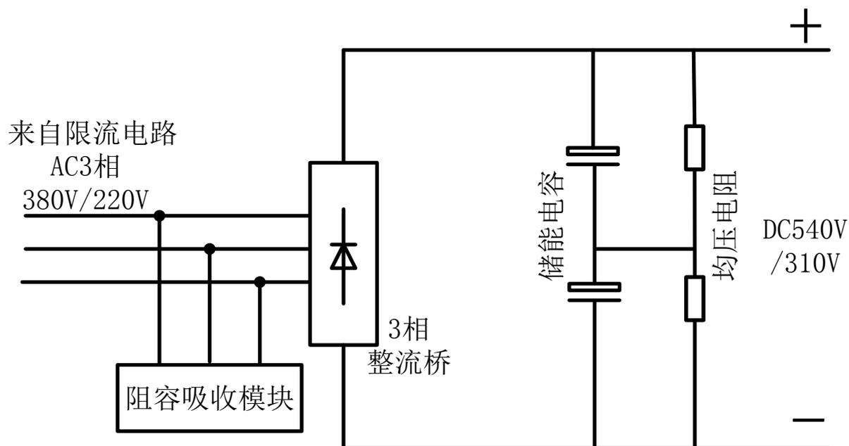
图七、整流及储能电路
