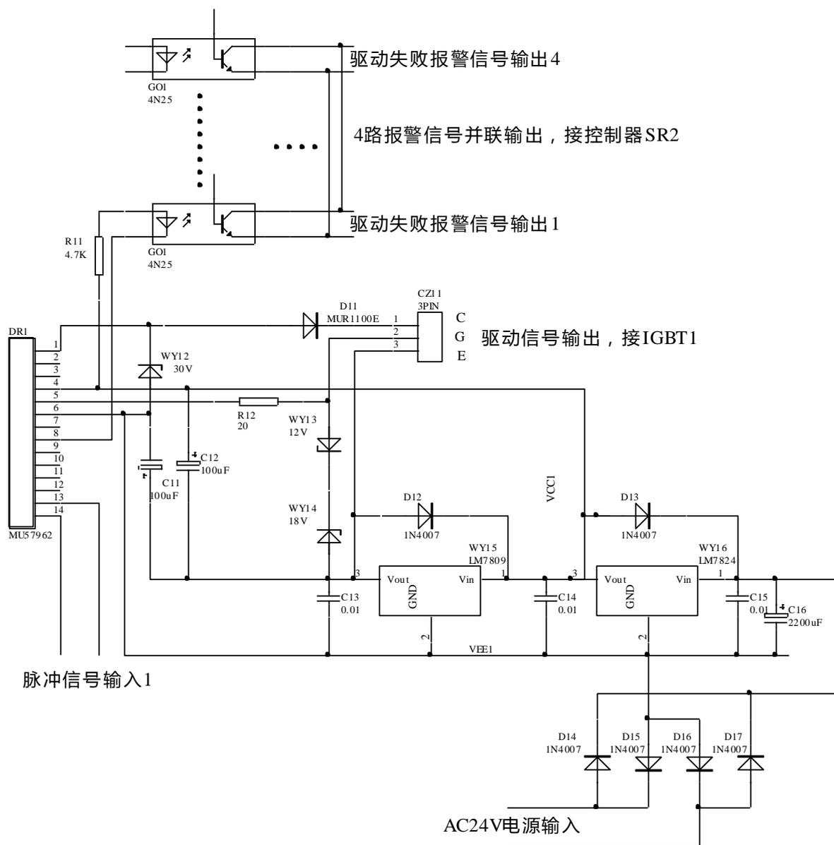
图十、驱动单元电路
