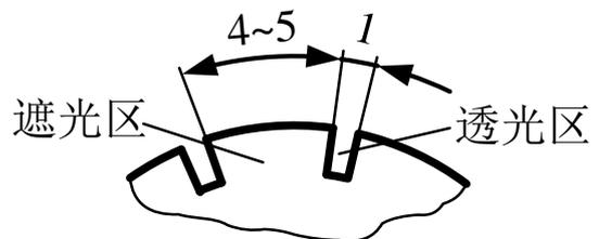
图三、计数盘透光槽宽度示意图
