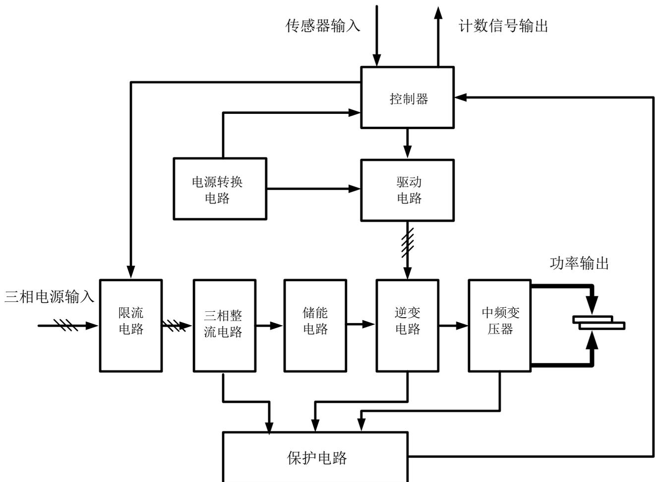
图五、电路结构框图
