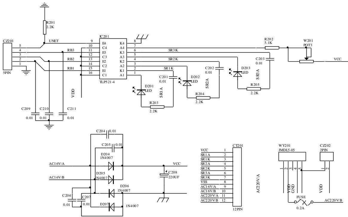
图十七、控制器电源电路
