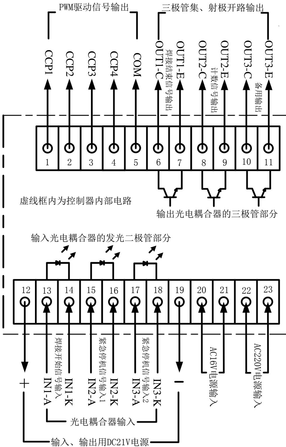
图十九、控制器外部接线图
