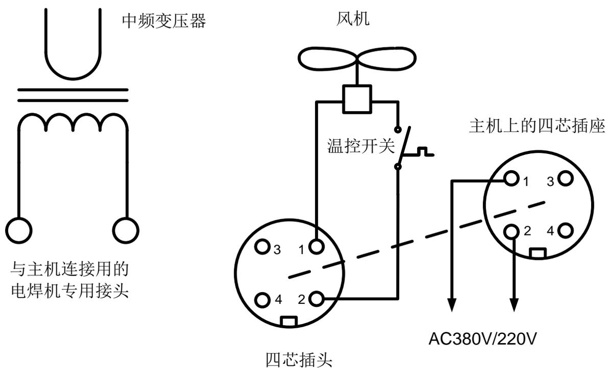
图十一、中频变压器单元电路
